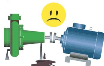
Un désalignement engendre des problèmes sur les garnitures et les joints d'étanchéité
