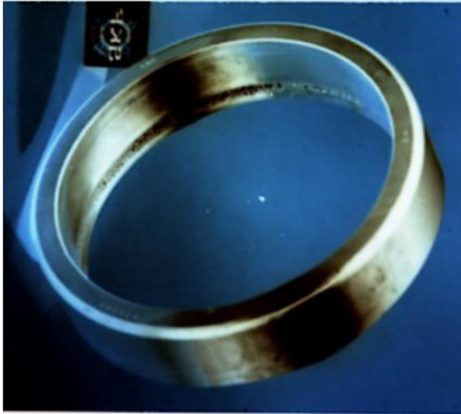
On remarque l'écaillage sur le chemin de roulement d'un seul côté.
