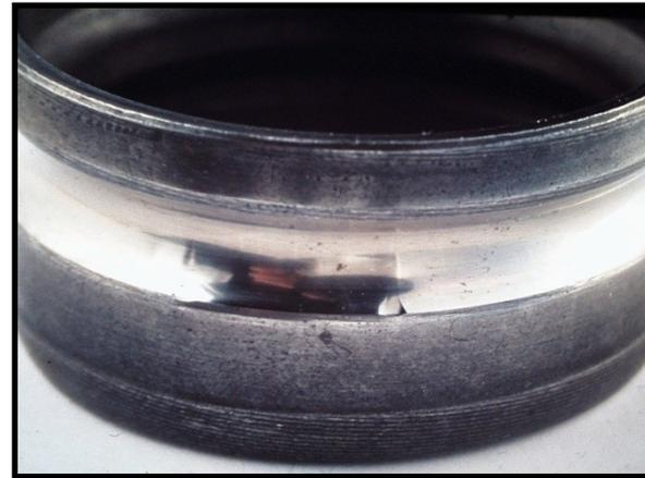
Empreintes au bord de la piste par montage dans l'arbre avec appui sur la bague extérieure
