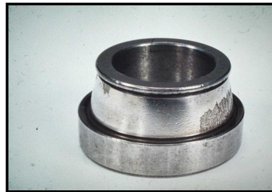
Détérioration du cône due à un défaut d'alignement
