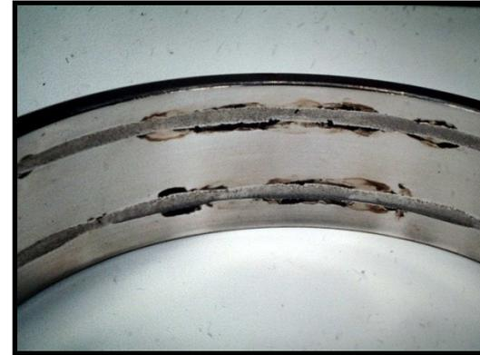
Oxydation et usure en rotation
