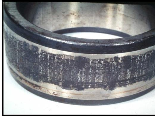
Oxydation en fonctionnement
