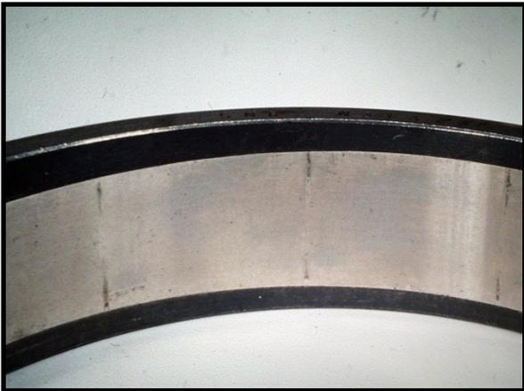
Arrachement de matière sur la piste par réalignement forcée
