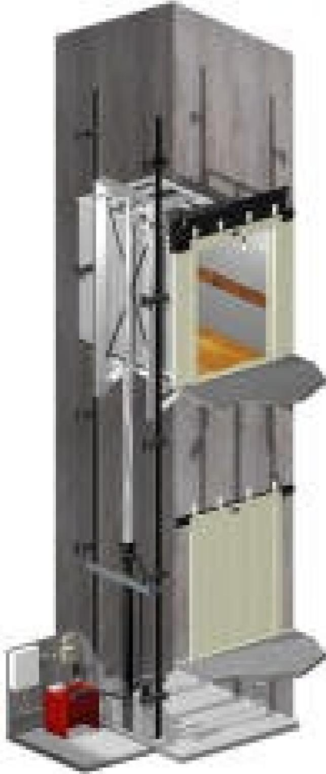
Ils ont pour particularité d'avoir un système différent pour le déplacement. En lieu et place d'un moteur de traction, ils possèdent un agrégat. Ils ne déplacent plus à la force électrique mais à la force hydraulique (auparavant) puis Oléodique
