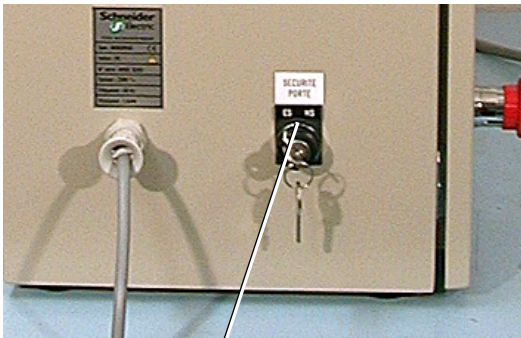
Commutateur à clé "Sécurité porte" sur position ES
