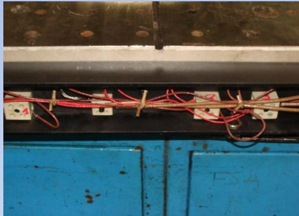
Bien entendu, la presse à injecter Maplan 3829 à aussi été arrêtée pour une action de maintenance préventive (changement des plaques isolantes entre le châssis de la machine et les nouveaux plateaux).
