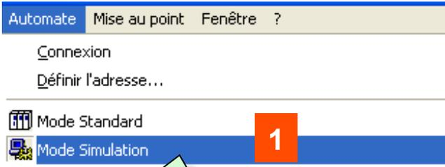
Sélectionner la **cible d'exécution** du programme par le menu **Automate / Mode simulation**.
