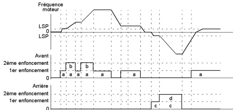
**NOTE :** Ce type de plus vite/moins vite est incompatible avec la commande 3 fils. Dans ce cas, la fonction moins vite est automatiquement affectée à l'entrée logique d'indice supérieur (exemple : LI3 (plus vite), LI4 (moins vite)).
