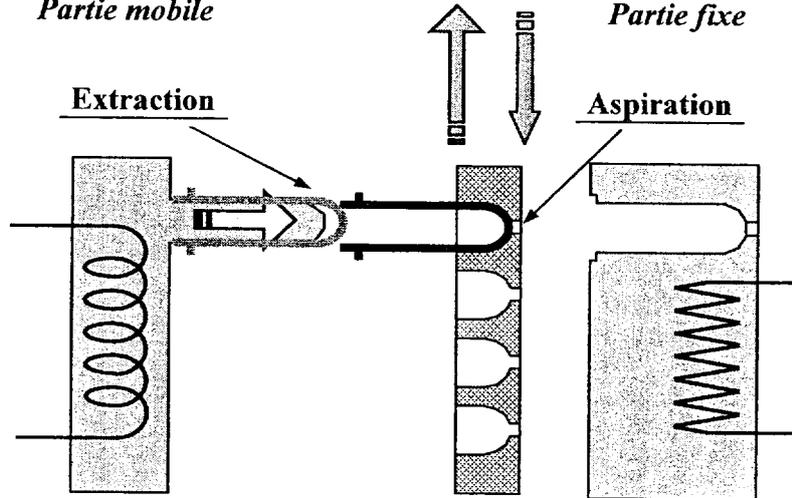
→ Transfert des paraisons, en position haute, du Robot V sur le Robot Horizontal
