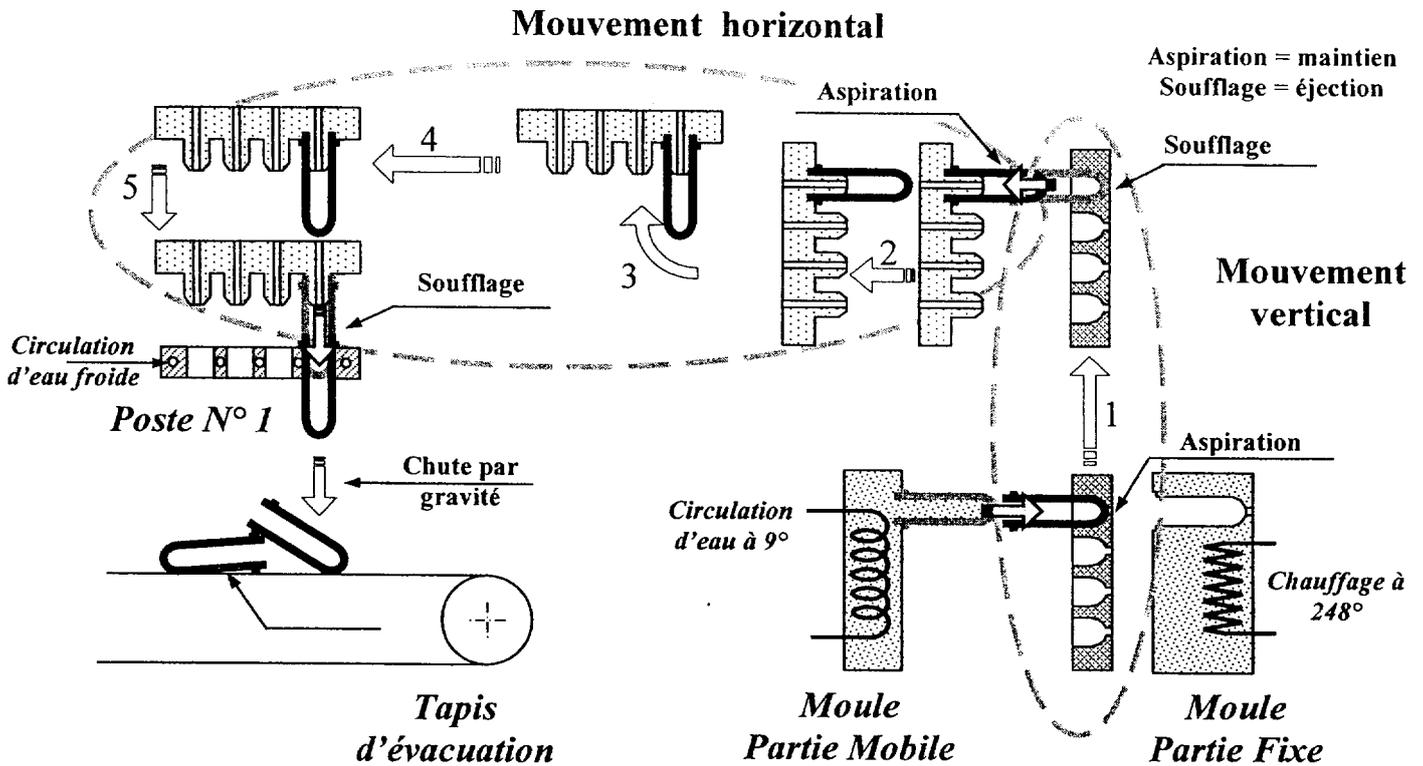
**Le Robot Vertical** est une unité de manipulation pour l'extraction des paraisons avec maintien de la géométrie. Il transfère les paraisons de la sortie du moule au Robot Horizontal. Le plateau de prélèvement commandé par un servo moteur
