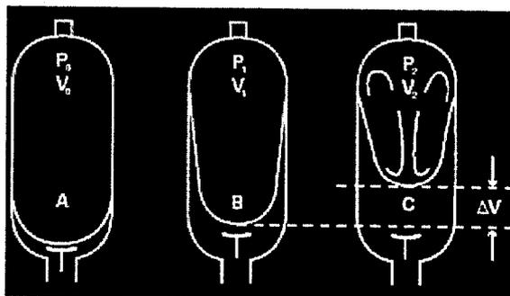
A – La vessie est dans la position de gonflage ce qui signifie qu'elle n'est remplie que d'azote. La soupape ferme l'orifice hydraulique et empêche la destruction de la vessie.
