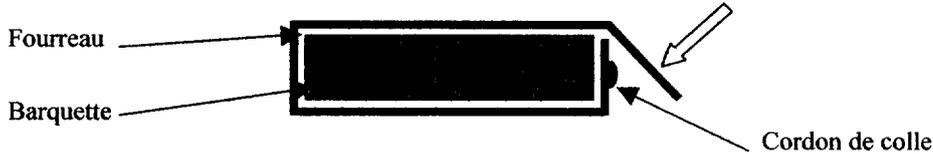
La constatation en fin de chaîne de plusieurs fourreaux mal ou non collés oblige à mettre en place à ce poste un système de contrôle du collage des fourreaux et d'évacuation des boîtes (fourreau+ barquette) dont le fourreau est mal collé.
