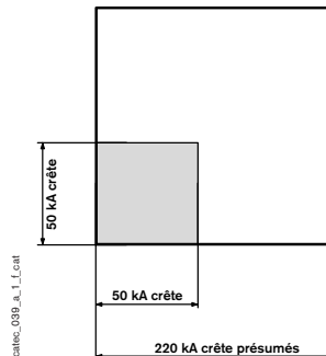
Fig. 3 : limitation des efforts électrodynamiques proportionnelle au carré du courant
