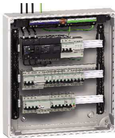
Coffret Pragma Evolution avec arrivée de la terre principale par le haut et parafoudre en haut : le bornier de terre est déporté au plus près du parafoudre
