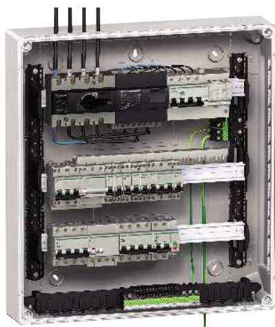
Coffret Pragma Evolution avec arrivée de la terre principale par le bas et parafoudre en haut : un bornier intermédiaire de terre (réf. PRA90053 + PRA90046) est déporté au plus près du parafoudre
