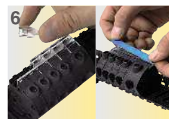
6 Mise en place des protections et du repérage
