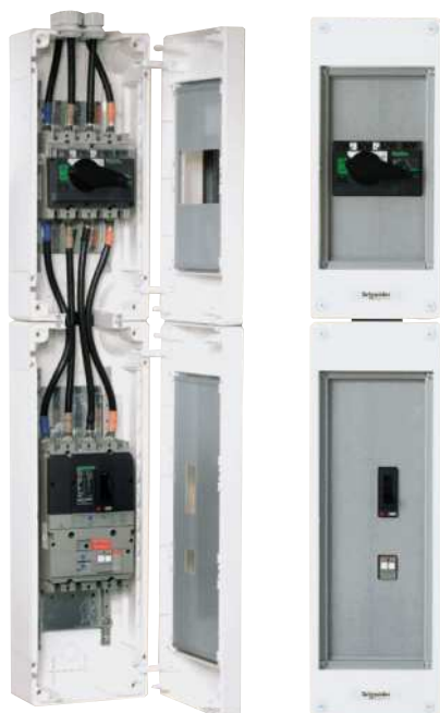
Exemple d'installation d'un Interpact INV + Vigicomcompact dans 2 coffrets d'interface. Références nécessaires : coffrets d'interface PRA06224 et PRA06324 + Kit "Interpact" PRA90068 + kit "Vigicomcompact" PRA90069 + liaison 04149
