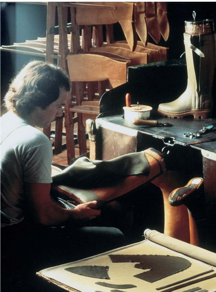
Assemblage d'une botte en caoutchouc par un maître botier (Le Chameau)
