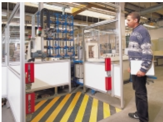
Barrières immatérielles XUS-L assurant la protection d'une zone dangereuse.
