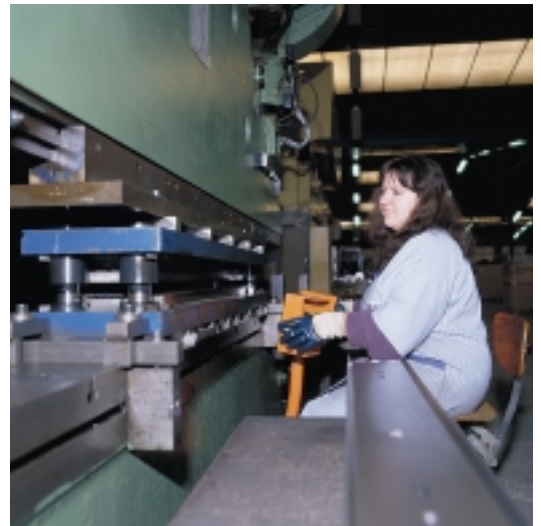
Le pupitre de commande bimanuelle Telemecanique garantit une sécurité totale pour l'opérateur.
