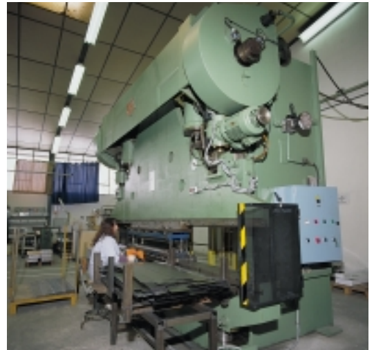
La presse poinçonneuse de 220 tonnes, objet de la mise en conformité.
