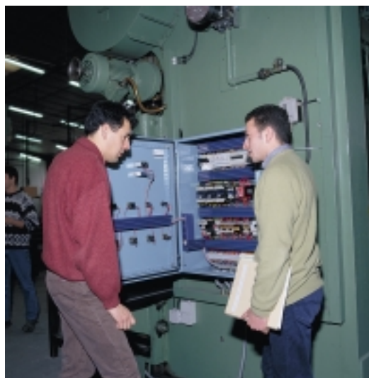
Jean-Yves Hernandez, professeur d'électrotechnique, et l'un des trois étudiants ayant réalisé l'automatisme de mise en conformité de la presse.
