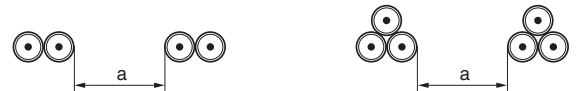
Fig. G18 : Valeurs du facteur de correction k_4 pour le groupement de plusieurs circuits, câbles directement enterrés – Mode de pose D (à partir du tableau 52-18 de la norme CEI 60364-5-52)
