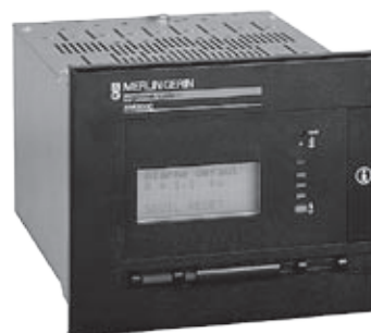
Fig. F16 : Contrôleur permanent d'isolement (CPI) obligatoire
