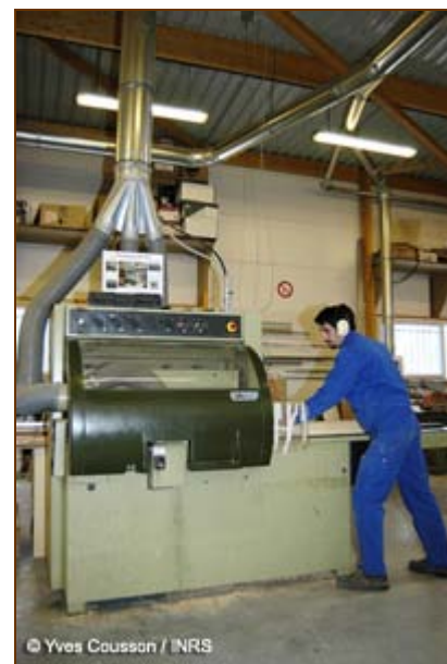
Captage de poussières de bois : raccordement des buses d'aspiration à un système centralisé
