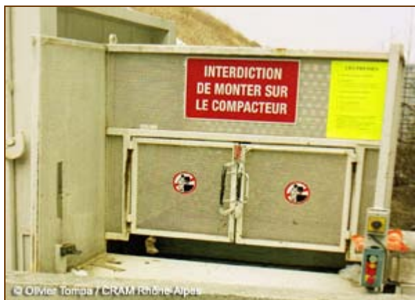
Exemple d'avertissements apposés sur un compacteur à déchets
