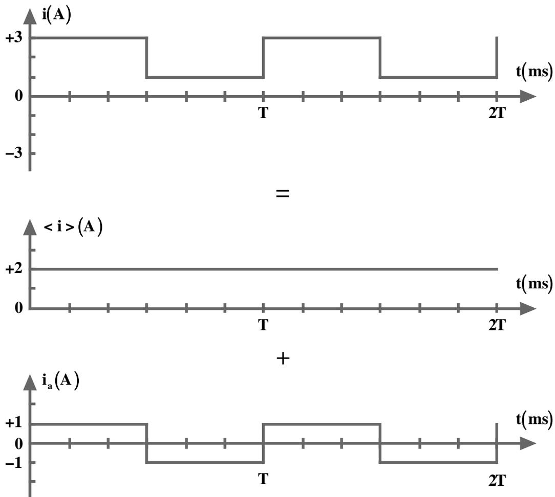
Ce signal  $i(t)$  se décompose comme la somme d'un signal continu correspondant à sa valeur moyenne  $\langle i \rangle$  et d'un signal alternatif  $i_a(t)$  correspondant à l'ondulation autour de sa valeur moyenne, soit :
