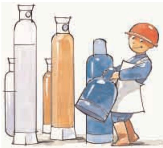
Le soudage utilise la chaleur de combustion d'un **gaz combustible** (généralement acétylène ou propane) mélangé dans certaines proportions à un **gaz comburant** (oxygène).
